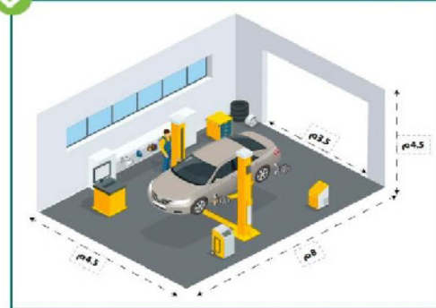
شكل توضيحي (4): رسم توضيحي لقسم ميزان السيارات
