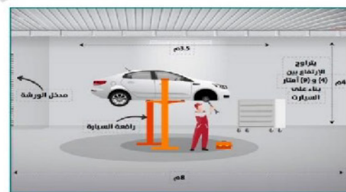
شكل توضيحي (3): رسم توضيحي جانبي وعلوي لقياسات قسم صيانة السيارات
